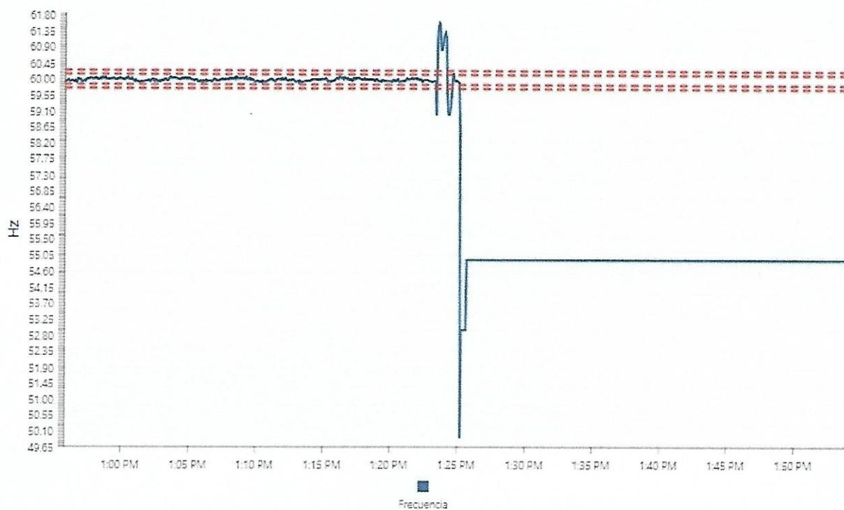
Figura 1: Frecuencia del SENI al momento de la falla e inmediatamente después.
